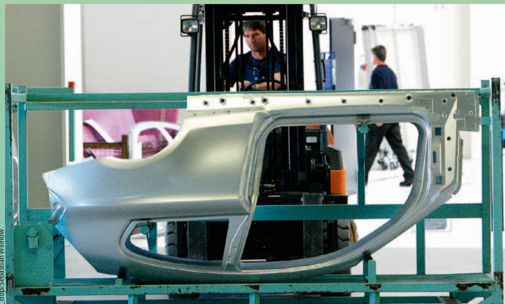
Gepresste Blechteile für PKW werden im BMW-Werk in Leipzig mit dem Gabelstapler transportiert
