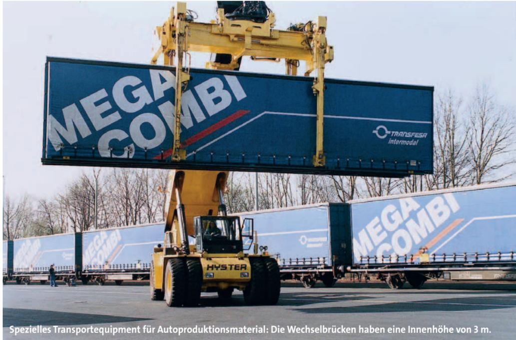
Spezielles Transportequipment für Autoproduktionsmaterial: Die Wechselbrücken haben eine Innenhöhe von 3 m.
